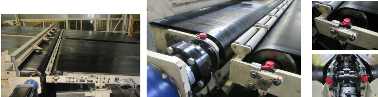
OBRÁZKY.: PÁSOVÉ DOPRAVNÍKY LISOVNE, UMIESTNENIE MERACÍCH ADAPTÉROV NA LOŽISKOVÝCH DOMCOCH VALCOV
